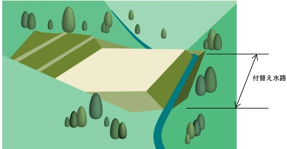
図 5.54 一般的な谷地造成付替え水路
