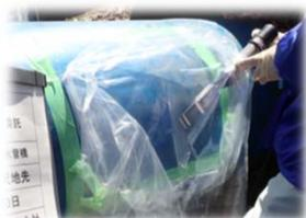
対象鋼構造物※2から塗膜を採取します。お客様による持込にも対応しています。(量の目安は100g/試料)
