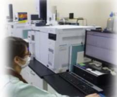
前処理後の溶出液をガスクロマトグラフィー質量分析装置(GC/QMS)等を用いて測定します。
