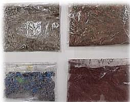
塗膜を粉碎または裁断し、試験試料とします。汚泥状のものについては小石等の異物を除去します。
