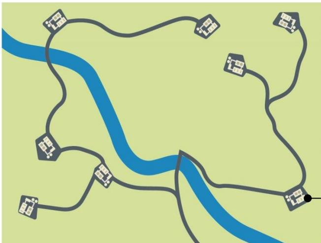
坑口発電ユニットは、生産井が掘削されてすぐに発電可能となる。ユニットは小型なため、大きな重機を利用した工事や管理も不要となる。次の掘削する際には、その電力を利用して作業することもできる。
