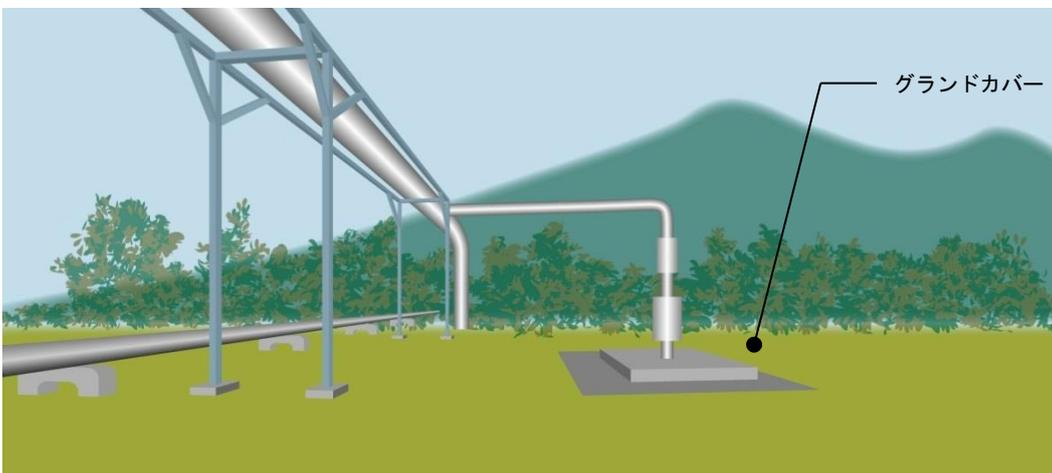
図 5.105 捨てコンクリート\*を最小限に抑えた坑井基地
