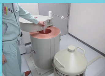
放射性物質測定 [ウェル型ゲルマニウム半導体検出器 ガンマ線スペクトルメータ]
