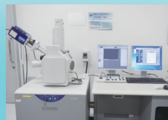
SEM, XMA [走査型顕微鏡およびX線マイクロアナライザー]
